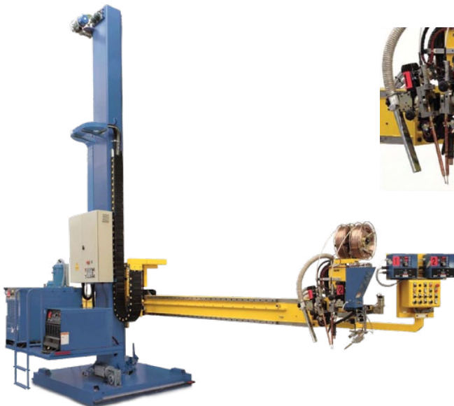
Применение манипулятора для сварки под флюсом с использованием технологии «тандем».
