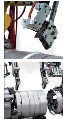
▲ Установка для MIG/MAG сварки деталей пищевых емкостей автоматической центровкой свариваемых деталей.
