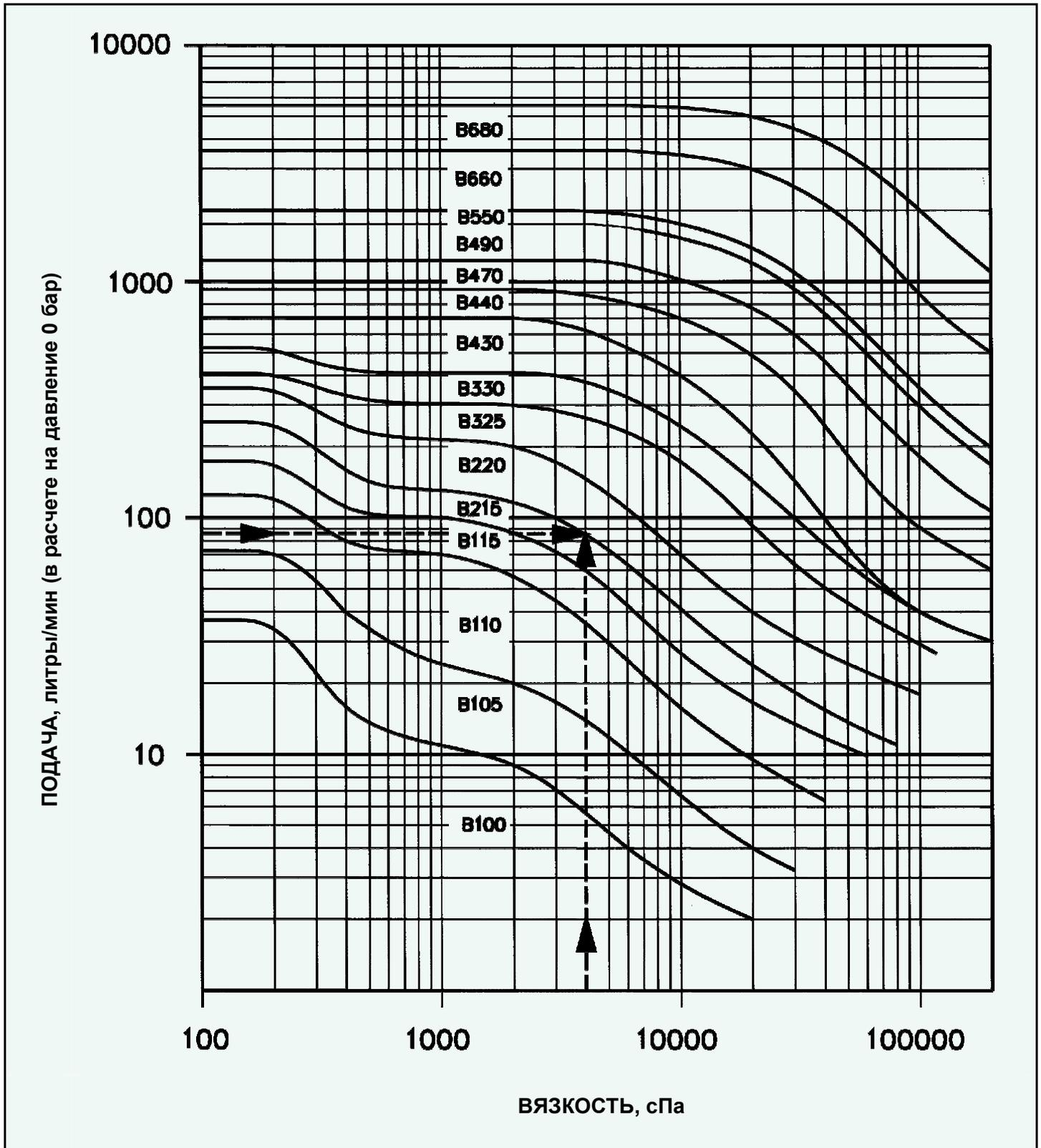
Кривые на этой диаграмме ограничивают область применения насосов различных типоразмеров, выбранных в первом приближении в зависимости от вязкости / подачи. Например, при: вязкости = 4000 сПа
