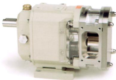
Насосы моделей В115, В220, В330, В440 могут быть изготовлены со всасывающим патрубком большей площади поперечного сечения прямоугольной формы. Это делается в целях облегчения подачи к насосу продуктов высокой вязкости, таких как тесто или густые смеси с полутвердыми элементами.
